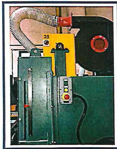
*Particolare della lama di soffiaggio e dei comandi di salita/discesa con riferimento sull'asta millimetrata.*
